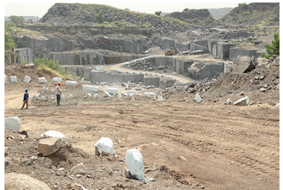
采石场地上的二氧化硅粉尘会通过风在空气中传播——应该在地上洒水以防扬尘。
