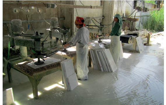
这些工人正在通风的场所工作，而且用水进行防尘。然而，还是应该使用防尘面具。
